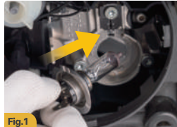
Fig.1 Retirar conector original, abrir clip de resorte y extraer bombilla
