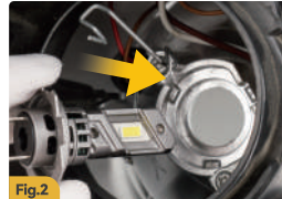
Fig.2 Inserte la bombilla en el conjunto alineando las pestañas del anillo con la ranura del conjunto
