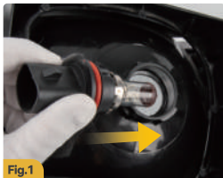
Fig.1 Retirar tapa antipolvo y bombilla original
